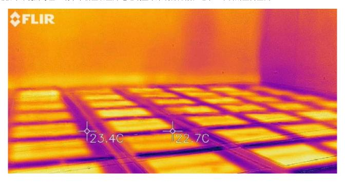
地暖正常情况下拥有50年的使用寿命,但如果常年不进行清洗,地暖的使用寿命也将会大打折扣。因为地暖系统在长时间运转过程中,难免受到干扰和破坏,所以一般地暖在两年左右清洗一次。过了采暖期以后,还需要对地暖进行维护、检测,才能确保地暖系统稳定高效,从而达到节能、使用寿命长久的功效。地暖有的人在使用中可能会犯以下几个错,结果是费力不讨好,会浪费很多钱。误区一:即用即开会节能?有的消费者会在需要的时候打开温控,出门的时候关闭温控,以为这样会省,其实这样不但不节能反而会更耗能。地暖系统是一个低温运行的系统,通常地暖的热水盘管都是铺设在混凝土里面,所以地面辐射供暖系统具有良好的蓄热性,在这种情况下地暖系统的使用效果就具有了滞后性。频繁的开启或关闭采暖系统会降地暖系统的使用寿命。正确做法:长期不用的房间可不开启地暖,在较长时间离开屋子的时候只需将温控器温度下调几度,在长时间不住人或者长时间离开的情况下可以选择关闭系统。但是需要注意的是如果房间有设备或者管道怕冻坏的情况下,还是要开启到一定的温度防止设备或者管道冻裂。
